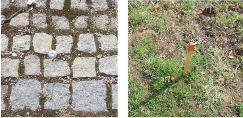
Obr. 2. Ukázky stabilizace stanovišek měřické sítě.
